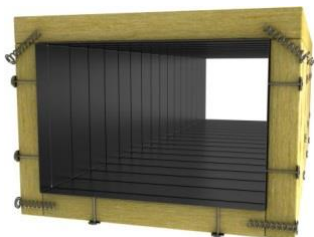
6.1 pav. Izoliacinių plokščių montavimas horizontaliam kanalui
