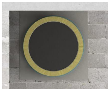
5.5 pav. Ortakio izoliavimas kai atstumas iki konstrukcijos \leq 200\text{mm} ir daugiau nei izoliacijos storis
